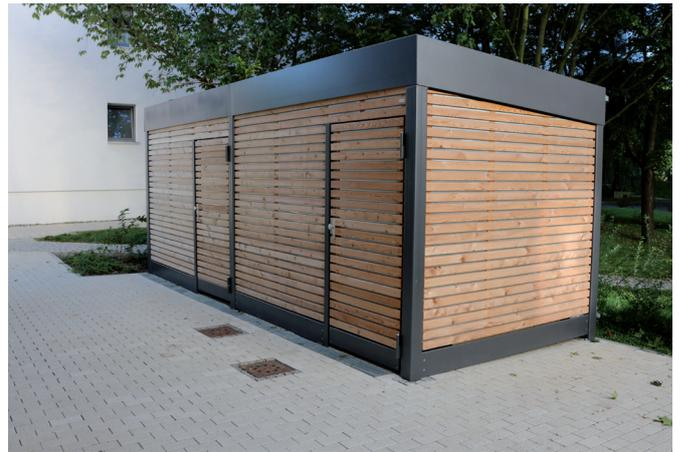
12 Gerätehaus Stahlkonstruktion mit durchlässiger Lattung
